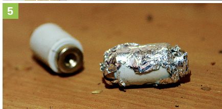
1 Laieninstallation, 2 defektes Sicherungselement, 3 defekte Abdeckungen, 4 alte Scherenleuchte, 5 defekte Sicherung, 6 Porzellan-Steck- und -Abzweigdosen
